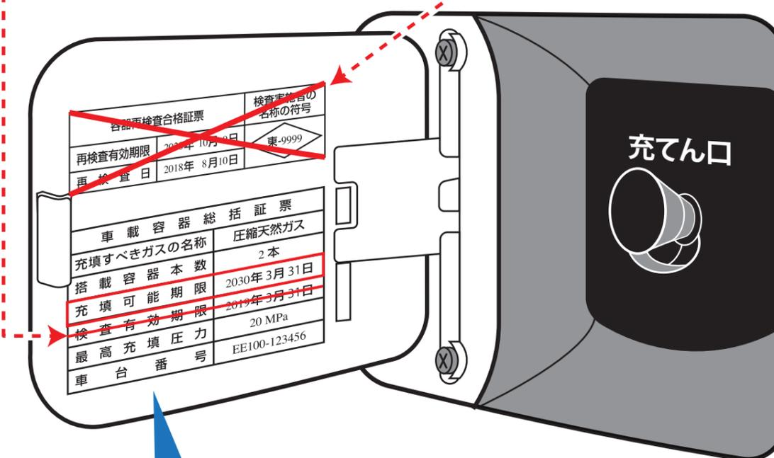
充填可能期限は、燃料ガス（CNG）充填口近傍に貼付されている車載容器総括証票に記載されています
