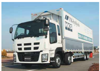
大型天然ガストラックのモニター車。いすゞGIGA(車両総重量25t)をディーゼルから天然ガス用に改造した。
