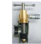
「サーチャー遮断工具(筑紫ガス=地方技術開発活性化支援テーマ) 経年供内管の対策や漏洩調査では既設のサービスターにゴムストップバーを挿入してガスを遮断するが、抜けの不安やエア抜きが必要があった。本品はねじ込み式で抜けをなくし、エア抜きを不要として作業時間の短縮を図った。
